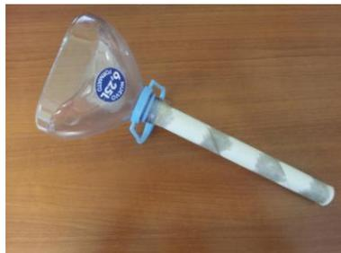
3. Fijar el micrófono en el interior del tubo de cartón con el límite del tapón de la botella.
