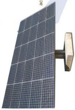
**PLACA FOTOVOLTAICA CON SEGUIDOR:** Son estructuras compuestas por láminas de células fotovoltaicas fabricadas con silicio monocristalino y elementos químicos como Fosforo y Boro. Al incidir el sol sobre la placa los electrones del P y B se excitan saltando de una órbita a otra, produciendo electricidad que es acumulada en forma de corriente continua, pasando por un convertidor y se transforma en corriente alterna produciendo 5000 W.
